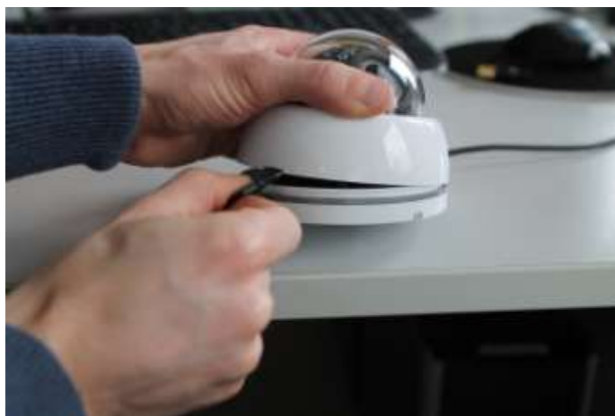
Bild 1: Öffnen des Kameragehäuses (mit Gehäuseöffner):
