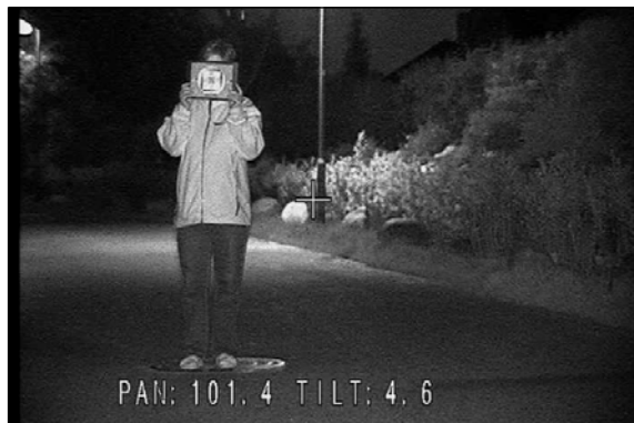
40 m zur Person (IR-LED an, geringe Restbeleuchtung)
